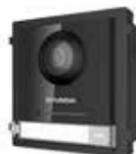
Stazione di videocitofono IP HYUNDAI NEXTGEN con camera fisheye di 2MP. Pulsanti fisici. Funzione di controllo di accessi. Incorpora microfono e altoparlante. Fast Ethernet. 4 entrate / 2 uscite di allarme. 12V CC. PoE.
