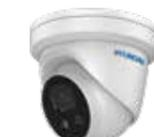
Dome fisso IP di 2MP con illuminazione infrarossi 50m, adatto per esterni. Formato H.265/H.264/MJPEG. CMOS 1/2,8" di 2MP. Risoluzione digitale di 2MP25 ips. Filtro ICR. 0,012 lux. Ottica fissa di 2,8 mm (108°). OSD, AGC, BLC, WDR real 120dB, 3D-DNR, 1 zona ROI fissa. IVS. Pulsante reset. MicroSD. Onvif, ISAPI. IP67. 3AXIS. 12V CC. PoE.
