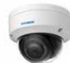
Dome fisso IP di nuova generazione HYUNDAI con Smart IR di 30 m per esterno. CMOS 1 / 2,8 "da 2 MP. Triple Stream. Formati di compressione H.265 +, H.265, H.264 +, H.264 e MJPEG. Risoluzione fino a 1080P a 25 ips. Filtro ICR. 0,005 lux F1.6. Ottica fissa da 2,8 mm (107 °). OSD, AWB, AGC, BLC, WDR 120dB, 3D-DNR, ROI, sensore video e maschere privacy. Intelligence IVS. Riconoscimento facciale. Onvif (S / G), ISAPI. IP67. 3AXIS. 12V DC. Supporta PoE
