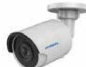
Camera bullet IP HYUNDAI NEXTGEN da 2MP con illuminazione infrarossi 30m, adatto per esterni. Formato H.265+/H.265/H.264+/H.264/MJPEG. Triple stream. CMOS 1/2,8" di 2MP. Risoluzione digitale di 1080P25 ips. Filtro ICR. 0,028 lux. Ottica fissa di 2,8 mm (103°). OSD, AGC, BLC, HLC, WDR real 120dB, 3D-DNR, 1 zona ROI fissa. IVS. Rilevazione facciale. Pulsante di reset. MicroSD. Onvif, ISAPI. IP67. 3AXIS. 12V CC. PoE.
