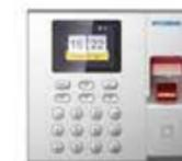
Terminale di controllo e presenza accesso autonomo HYUNDAI con lettura biometrica delle impronte digitali e lettore di schede EM. Fino a 1.000 impronte digitali, 1.000 carte, 1.000 utenti, 100.000 eventi e 50.000 presenze. Incorpora uno schermo da 2,4 ". Comunicazione TCP / IP. Ingressi per 1 sensore porta e 1 pulsante di uscita REX. Uscite per 1 relè serratura e 1 relè campanello. Non adatto per uso esterno.
