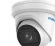
Dome HYUNDAI IP. 4 MP a 20 ips, H.265+/H.265. ICR, 0,005 lux, IR 40 m. Ottica motorizzata 2,8~12 mm. WDR 120dB, 3D-DNR, ROI. Protezione perimetrale e rilevamento facciale. 1 ingresso / 1 uscita audio. 1 ingresso / 1 uscita allarme. Slot MicroSD, Onvif, RJ45, IP67, IK10, 3AXIS, 12V/PoE
