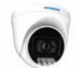
Dome fisso IP HYUNDAI con Smart IR 20 m all'aperto. Formato H.265 / H.264. CMOS 1 / 2.7 "di 5 megapixel. Risoluzione fino a 5MP 10 ips. Triple Stream Ottica fissa da 2,8 mm. Filtro ICR OSD, AWB, AGC, WDR digitale, 2D / 3D-DNR, 4 zone ROI, sensore video e maschere privacy. 1 ingresso / 1 uscita audio. ONVIF. IP67. 12V DC PoE. Pulsante di reset
