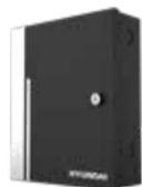
Controller di Controllo di Accessi. Controllo di accessi di due porte. Fino a 10.000 schede e 50.000 eventi. Comunicazione Uplink con TCP/IP. 4 Lettori Wiegand. Entrate per 2 sensori da porta, 2 pulsanti di uscita REX e 2 entrate di allarme. Uscite per 2 Relés di blocco della porta e 2 Relés di allarme.
