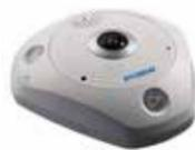
Dome fisheye IP HYUNDAI. 12MP 20ips, H.265+/H.265. ICR, 0,082/0,016 lux, IR 15m. Ottica fissa da 2 mm. WDR digitale, 3D-DNR, Defog, ROI. Intelligenza IVS. 1 ingresso / 1 uscita audio. 2 microfoni + 1 altoparlante. 1 ingresso / 1 uscita allarme. Slot MicroSD, Onvif, RJ45 Gigabit, IP67, IK10, 12V/PoE
