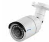
Telecamera bullet IP HYUNDAI con Smart IR da 25 m per esterni. Formato H.265 / H.264. CMOS 1 / 2,7 "di 5 megapixel. Risoluzione fino a 5MP 10 ips. Triple Stream Ottica fissa da 3,6 mm. Filtro ICR OSD, AWB, AGC, WDR digitale, 2D / 3D-DNR, 4 zone ROI, sensore video e maschere privacy. 1 ingresso / 1 uscita audio. ONVIF. IP67. 12V DC PoE. Pulsante di reset
