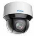
Dome PTZ IP HYUNDAI. 2MP 25ips, H.265+/H.264+. ICR, 0,005/0,001 lux, IR 50m. Zoom ottico 25X: 4,8~120 mm. BLC, HLC, WDR 120dB, 3D-DNR, Disappannamento. PanTilt: 360°300°/s (H); 90°160°/s(V); 300 preimpostazioni. Audio bidirezionale. 2 ingressi / 2 uscite di allarme. Slot MicroSD, RJ45, Onvif, IP66, PoE+
