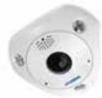
Dome fisheye IP con illuminazione infrarossi 15m, antivandalico da esterno. Formato H.264/MJPEG. Risoluzione digitale: 12MP (4000x3072), ecc. Ottica fisheye di 1,98 mm, 360°. OSD, AGC, BLC, WDR digitale, 3D-DNR, 4 zone ROI. Funzioni intelligenti (IVS). Entrata MicroSD/SDHC/SDXC. IP66, IK10. 12V CC. PoE.
