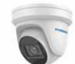
Dome fisso IP HYUNDAI NEXT GEN Performance Line con illuminazione a infrarossi 30m da esterno da 4 megapixels. Formato H.265+/H.265/H.264+/H.264/MJPEG. CMOS 1/3" da 4MP. Risoluzione di fino a 4MP20FPS. Filtro meccanico. 0,02 lux. Ottica motorizzata di 2,8 ~ 12 mm (92,8°~29°). OSD, AGC, BLC, WDR 120dB, 3D-DNR, videosensore, privacy mask, zona ROI fissa. IP67. 3AXIS. 12V CC. PoE.
